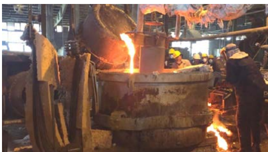
شکل ۲. تخلیه مذاب سرباره کوره بلند ذوب آهن اصفهان به داخل کوره ذوب.
