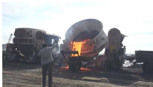
شکل ۱. تخلیه مذاب سرباره کوره بلند ذوب آهن اصفهان به پاتیل قابل حمل.
