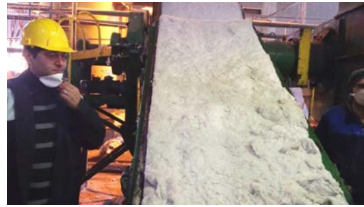
شکل ۳. پشم سرباره تولیدی (محصول) از سرباره مذاب کوره بلند ذوب آهن اصفهان.
