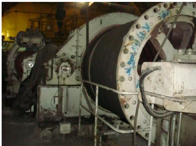
شکل شماره (6) - نمایی از محل نصب سیستم موتور اسکپ و بارابان کوره بلند شماره 1 ذوب آهن اصفهان
